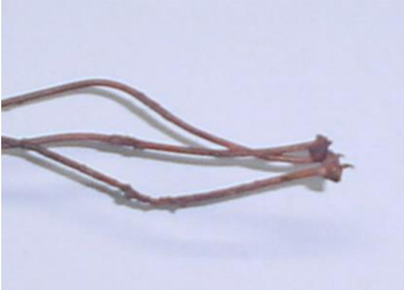
Este se produce al juntarse un positivo con un neutro y mantener su unión por un tiempo determinado.
